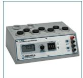
S503 Taşınabilir Nem Kalibratör nem sensörleri, transmitterlerin ve taşınabilir cihazların hızlı ve doğru, s
