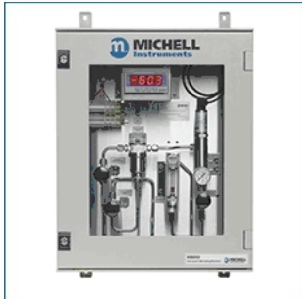
ES20 Kompakt Örnekleme sistemi, güvenilir ve doğru olarak 20 bar'a kadar endüstriyel gaz, çeşitli çiy no
